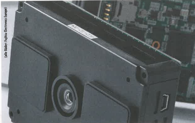
Bild 1. Industrielle 3D-ToF-Keramodule, wie das hier von Inrevious, ermitteln den Abstand von Objekten zu jedem Pixel des Bildsensors zwischen 0,3 und 9,6 Metern.
