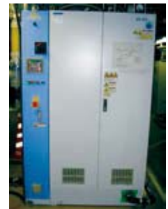
高效燃燒性除害裝置
