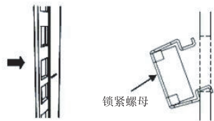
图 8-44 锁紧螺母的钩子方向
