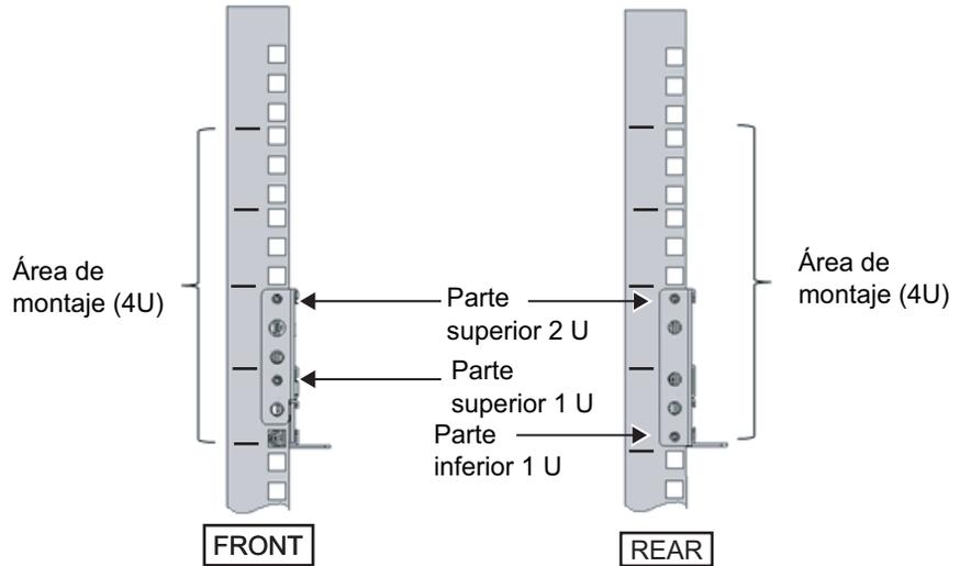
Figura 8-9 Conexión de la guía: ubicación de fijación del tornillo
