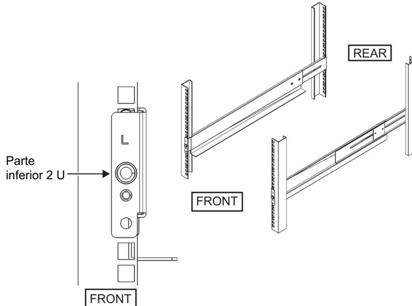
7. **Conecte la abrazadera de fijación del soporte para cables a la columna de apoyo posterior del bastidor.**
