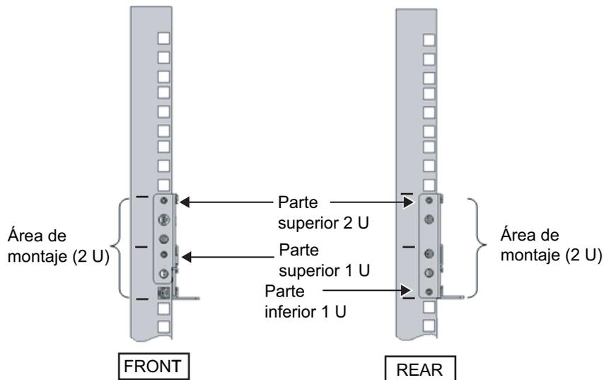
Figura 8-30 Conexión de la guía: ubicación de fijación del tornillo
