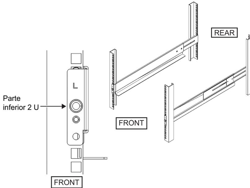
6. **Conecte la abrazadera de fijación del soporte para cables a la columna de apoyo posterior del bastidor.**
