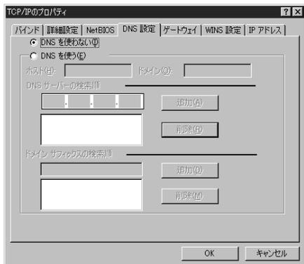
7. DNS サーバの IP アドレスが固定かそうでないかによって設定方法を選択します。
