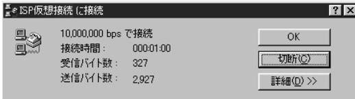
**補足** NetVehicle、パソコン間が LAN でつながっているため、「ISP 仮想接続に接続」画面上には、「10,000,000bps で接続」と表示されます。
