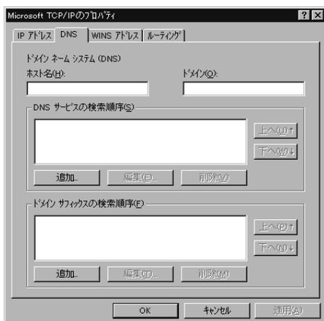
9. DNS サーバの IP アドレスが固定かそうでないかによって設定方法を選択します。
