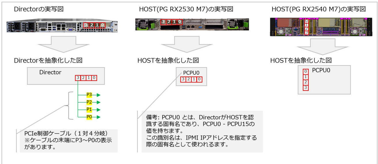
図 A-4 PCIe ケーブル接続図凡例(4/4)
