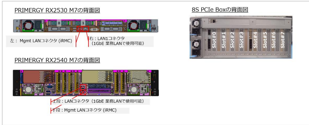
図 2-19 各コンポーネントの業務 LAN コネクタ図
