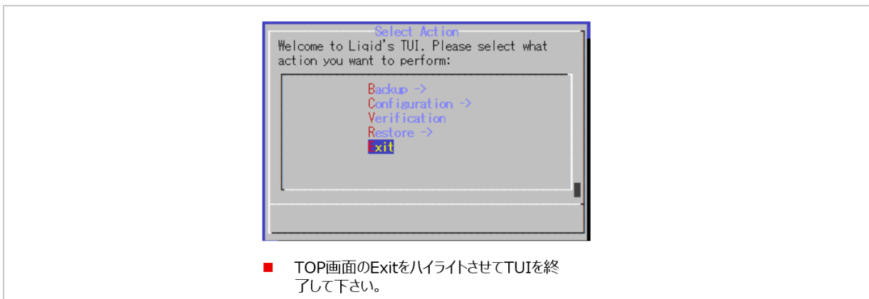
図 4-11 TUI による初期バックアップ手順(3/3)
