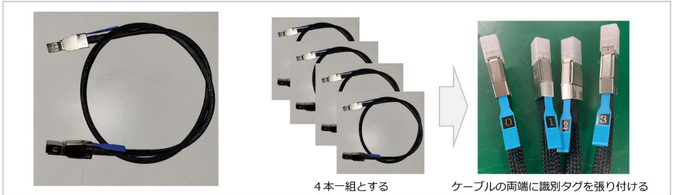
図 3-7 PCIe データケーブルの外観と識別タグの取り付け
