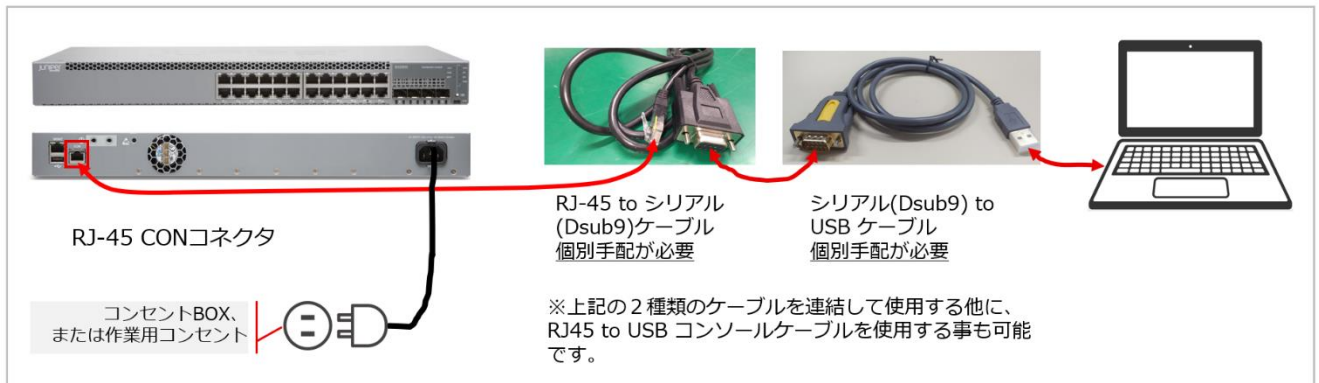
図 4-18 EX2300-24T と作業用 PC の接続例
