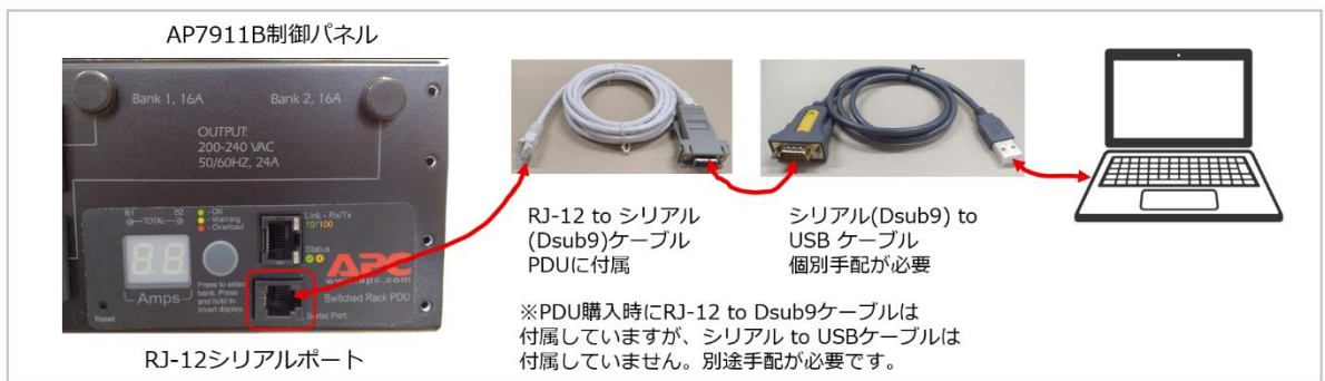
図 3-1 AP7911B 制御パネルと作業用 PC の接続図
