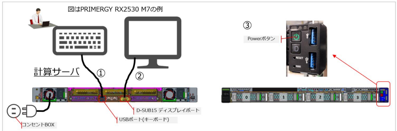
図 4-14 PRIMERGY ローカル接続図
