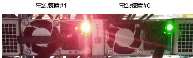
図1. PCIe ファブリックスイッチ前面の電源装置 (PSU) (PF 表示の例)
