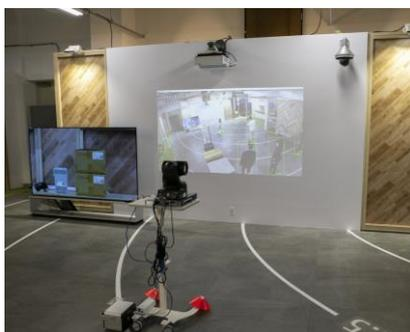
高精細映像（4K映像）をローカル5Gを活用して伝送することで、目視が難しい距離からでも荷物に貼付された二次元バーコードを読み取ることが可能
