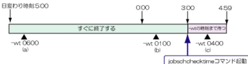
時刻待ち合わせジョブ(jobschchecktimeコマンド)が起動する時刻が、-wtで指定された待ち合わせ時刻より後であれば、ジョブ(コマンド)はすぐに終了します。また、時刻待ち合わせジョブ(jobschchecktimeコマンド)が起動する時刻が、-wtで指定された待ち合わせ時刻より前であれば、待ち合わせ時刻までジョブ(コマンド)の実行を待ちます。
