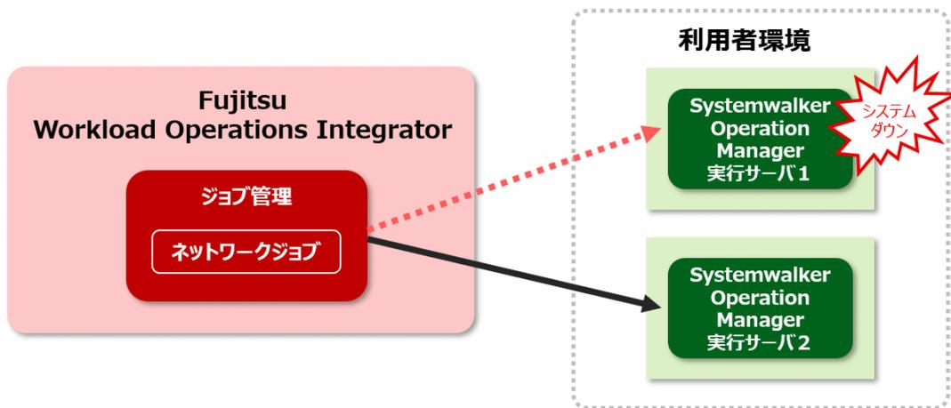
ネットワークジョブの実行サーバを二重化する場合、以下のいずれかの方法で第1候補、第2候補の実行サーバを登録してください。
