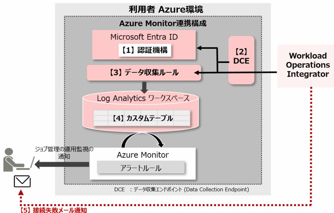
Azure Monitor連携では、ジョブ管理ログを利用者のAzure Monitorに送信します。以下の設計を行ってください。
