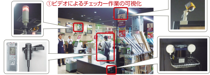
①ビデオによるチェッカー作業の可視化 ②測域センサーによるレジ待ちの可視化 ③音声認識によるチェッカー声掛けの可視化 測域センサー、ビデオ、音声認識を活用して、人手では発見できなかったレジ業務の事実を、次々に可視化した。
