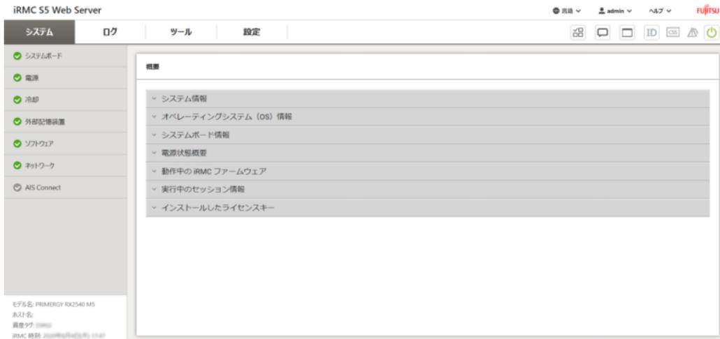
3. [設定] タブの [ネットワーク制御] を選択し、ネットワーク設定メニューにアクセスします。
