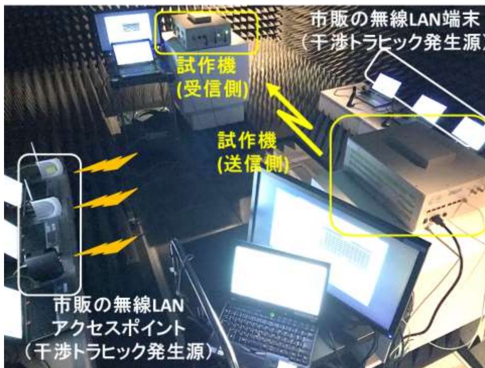
図-7 試作機による電波暗室での伝送実験
