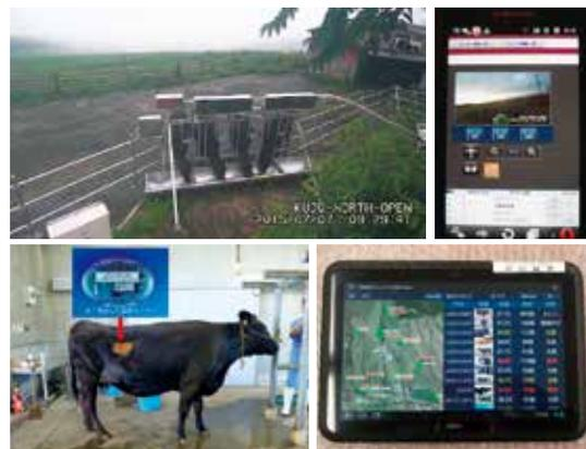
センサーで個体情報を管理できれば、放牧中も遠隔で牛を管理できる。スマホで給餌や測位も可能なシステムを目指している(機器は全て実験中の試作品)。
