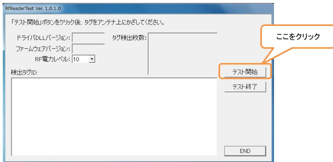
(3) アンテナから 10cm 程離れた場所にタグをかざすと、画面の「タグ検出枚数」と「検出タグ ID」欄に、検出したタグ枚数とタグ ID が表示されます。タグ枚数とタグ ID が表示されることを確認したら、「テスト終了」ボタンをクリックします。
