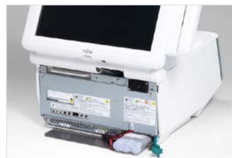
バッテリー交換 ※8
