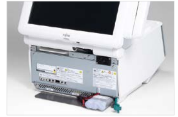
バッテリー交換 ※8
