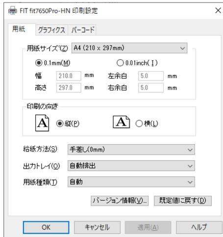
各アプリケーションソフトでのプリンターの設定項目から表示するプリンターのプロパティです。印刷時に用紙サイズやグラフィクス設定などの印刷に関する設定が行えます。
