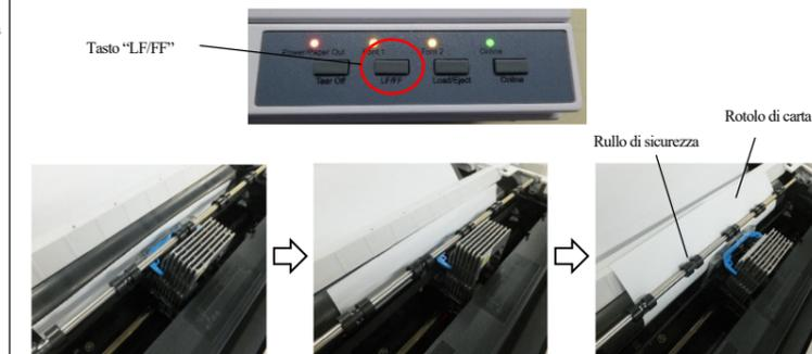
Operazione avanzamento linea per 0 volte. (durante un set) Operazione avanzamento linea per 3 volte. (durante un set) Operazione avanzamento linea per 5-10 volte. (L'impostazione è completa quando il rullo di sicurezza trattiene il rotolo di carta.)
