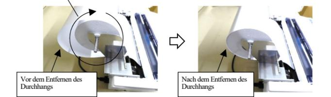
3-6. Drücken Sie die „LF/FF“-Taste auf dem Druckerbedienfeld, um den Zeilenvorschubvorgang durchzuführen. Wiederholen Sie den Vorgang, indem Sie die „LF/FF“-Taste drücken, bis die Bügelrolle geschlossen ist und das Rollenpapier hält. (Ungefähr 5-10 Tastendrucke sind erforderlich.)
