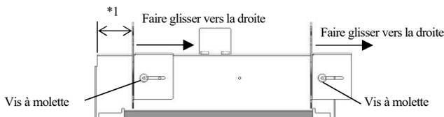
2-4. Faire passer de sorte que l'extrémité du rouleau de papier se trouve sur le côté inférieur. L'axe peut être passé par la gauche ou la droite du rouleau.
