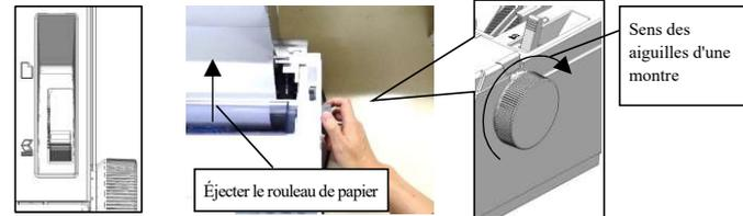
3-4. Lorsque le rouleau de papier est réglé, déplacez le levier de sélection de papier vers l'avant sur «» pour le mode d'alimentation par friction.
