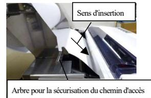
3-3. Déplacer le levier de sélection du papier vers l'arrière sur «» pour une position de papier continue. Puis tourner le bouton d'alimentation du papier dans le sens des aiguilles d'une montre pour éjecter le rouleau de papier.
