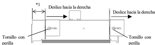
2-4. Pase el eje de forma que la punta del papel del rollo esté en el lado inferior. El eje puede pasar por la izquierda o por la derecha del rodillo.
