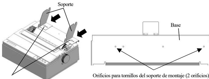
Coloque el soporte de modo temporal aproximadamente en la posición que se muestra a continuación. Deslice los soportes izquierdo y derecho hacia la derecha, respectivamente, y colóquelos contra los tornillos. A continuación, apriete los tornillos. (para referencia \*1 42 mm)
