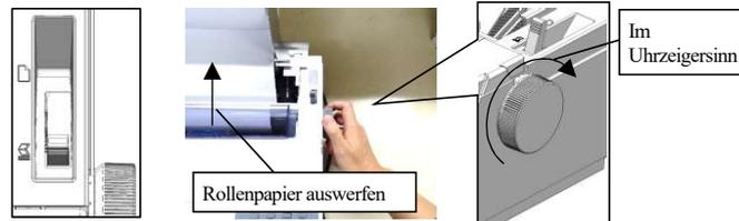
3-4. Wenn die Papierrolle eingestellt ist, schieben Sie den Papierwahlhebel nach vorn auf „“, um den Friktionszufuhrmodus auszuwählen. Drücken Sie die „LF/FF“-Taste, bis die Bügelrolle geschlossen ist.
