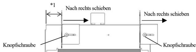
2-4. Führen Sie die Welle so, dass sich die Papierspitze der Rolle auf der Unterseite befindet. Die Welle kann von der linken oder rechten Seite der Rolle geführt werden.
