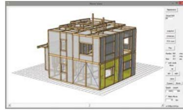
STRDESIGNで作成した建物データを wallstat で表示した例
