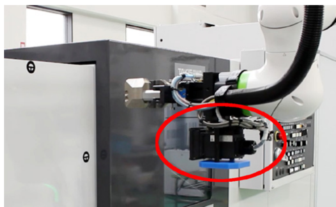
ロボットシステムのハンド部に装着されたカメラ。従来は位置決めのみで使用していたが用途拡大を検討した 提供：滝澤鉄工所
