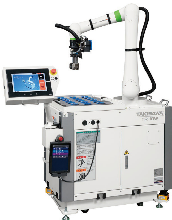
ワークの出し入れを簡単自動化できるロボットシステム「TR-10W」 提供：滝澤鉄工所
