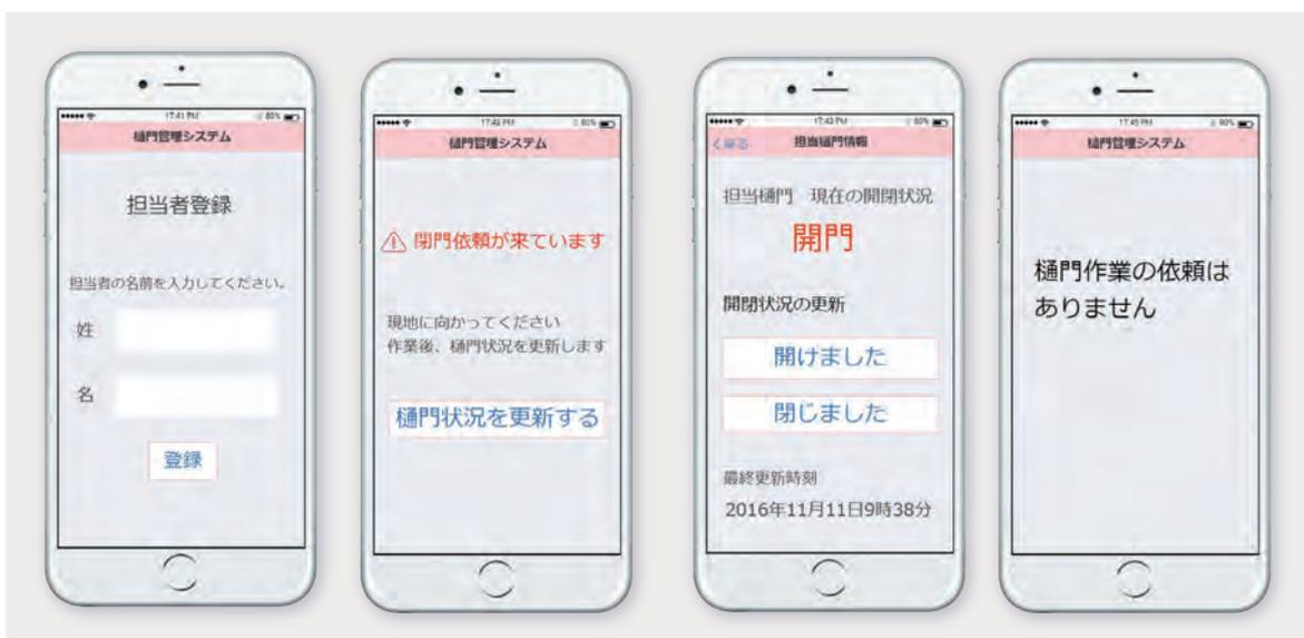
図3: モックアップの例。実際に動くものである必要はない。一連の流れができたら、想定ユーザーに見せてフィードバックをもらう
