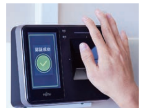
AuthGateによる入退室管理。手のひら静脈のみでの認証が可能
