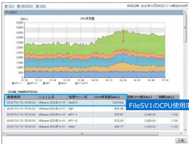
VMware ESX5-1 の CPU 使用率(上位 5 件の積み上げ)
