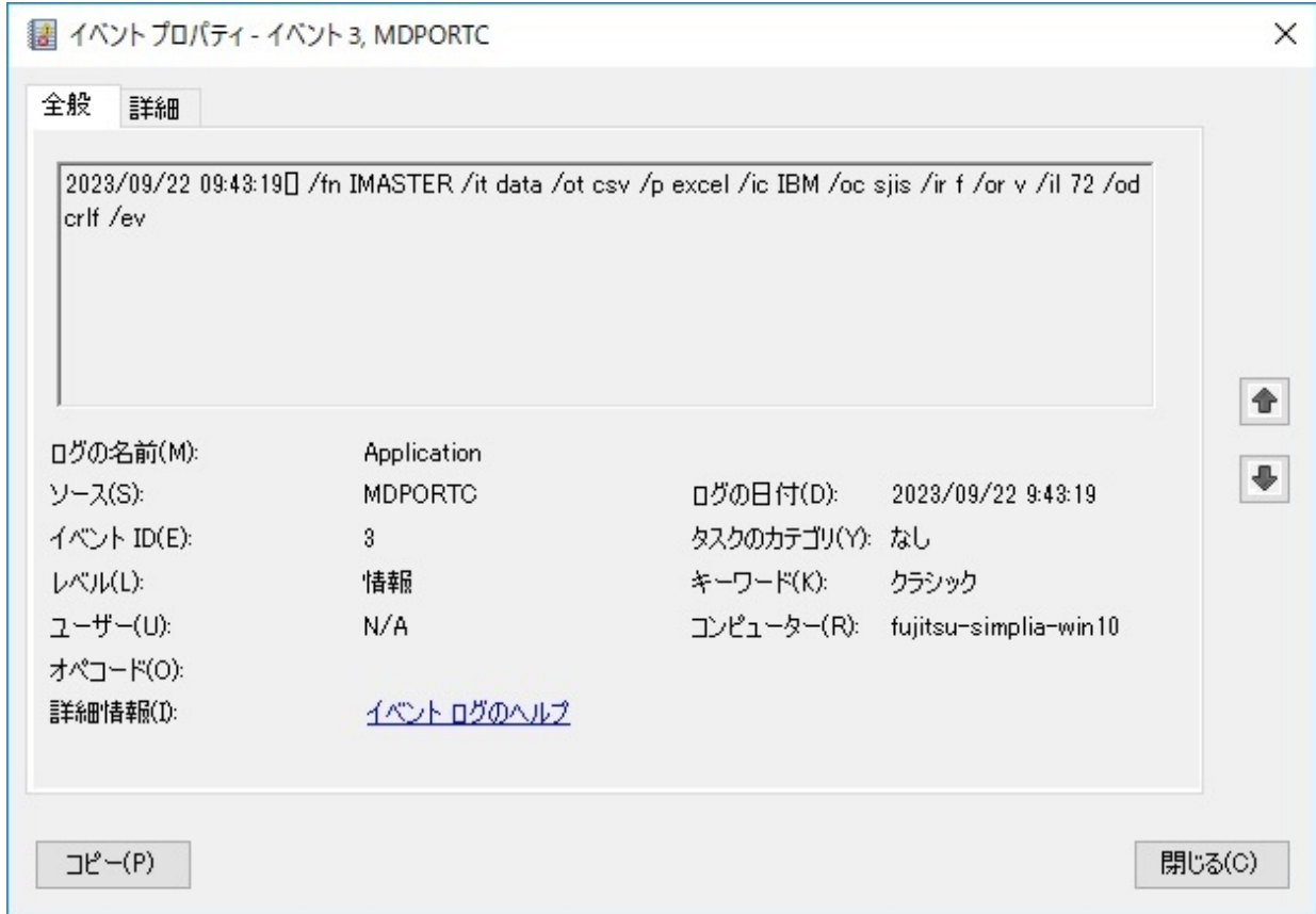
図A.6 イベントログ出力例 (実行コマンドのオペランド情報)
