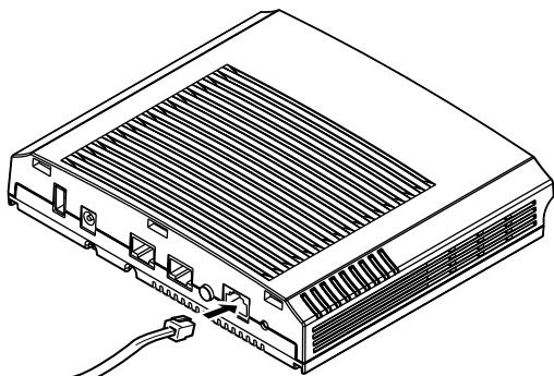
3. 先の細いもので本装置底面のリセットスイッチを押しながら、本装置に給電装置からのツイストペアケーブルを差し込みます。
