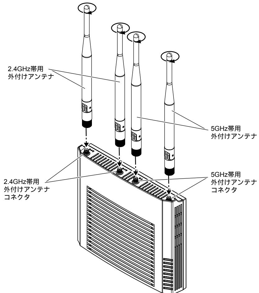
3. 外付けアンテナを折り曲げる場合は、下図の矢印の方向に動かします。
