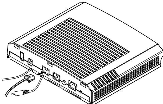
3. 先の細いもので本装置底面のリセットスイッチを押しながら、本装置の電源コネクタにACアダプターを差し込みます。
