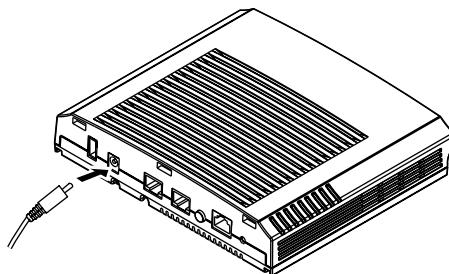
2. 本装置の底面にある AC アダプター抜け防止の溝に、AC アダプターのケーブルを固定します。
