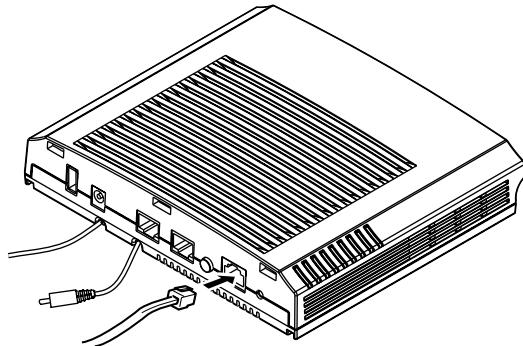
3. 先の細いもので本装置底面のリセットスイッチを押しながら、本装置の電源コネクタに ACアダプターを差し込みます。
