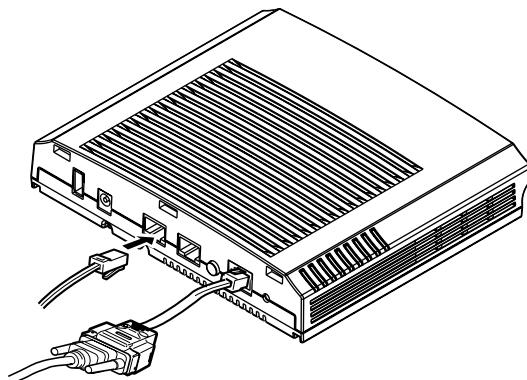
2. 10/100/1000BASE-T ポートに接続したツイストペアケーブルを給電装置に接続します。
