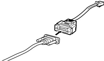
3. 本装置のコンソールポートにコンソールケーブルの RJ45 プラグを差し込みます。
