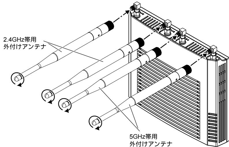
**4. 外付けアンテナを下図の矢印の方向に動かして、折り曲げます。**
