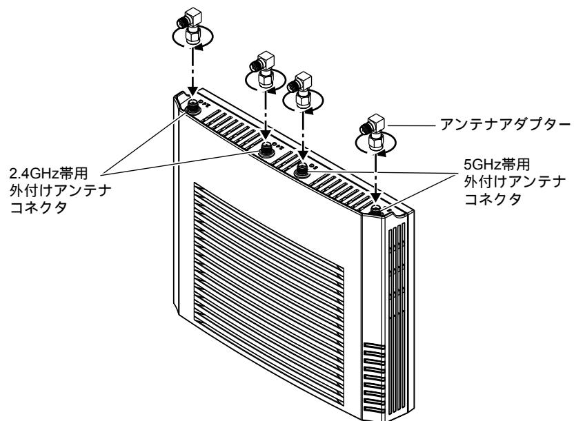
**3. 外付けアンテナをアンテナアダプターに差し込み、回して固定します。**
