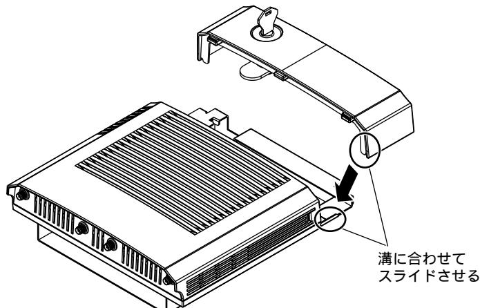
4. アクセスポイントセキュリティカバーを下図の矢印の方向に回転させながら、本装置にしっかりと、はめ込みます。
