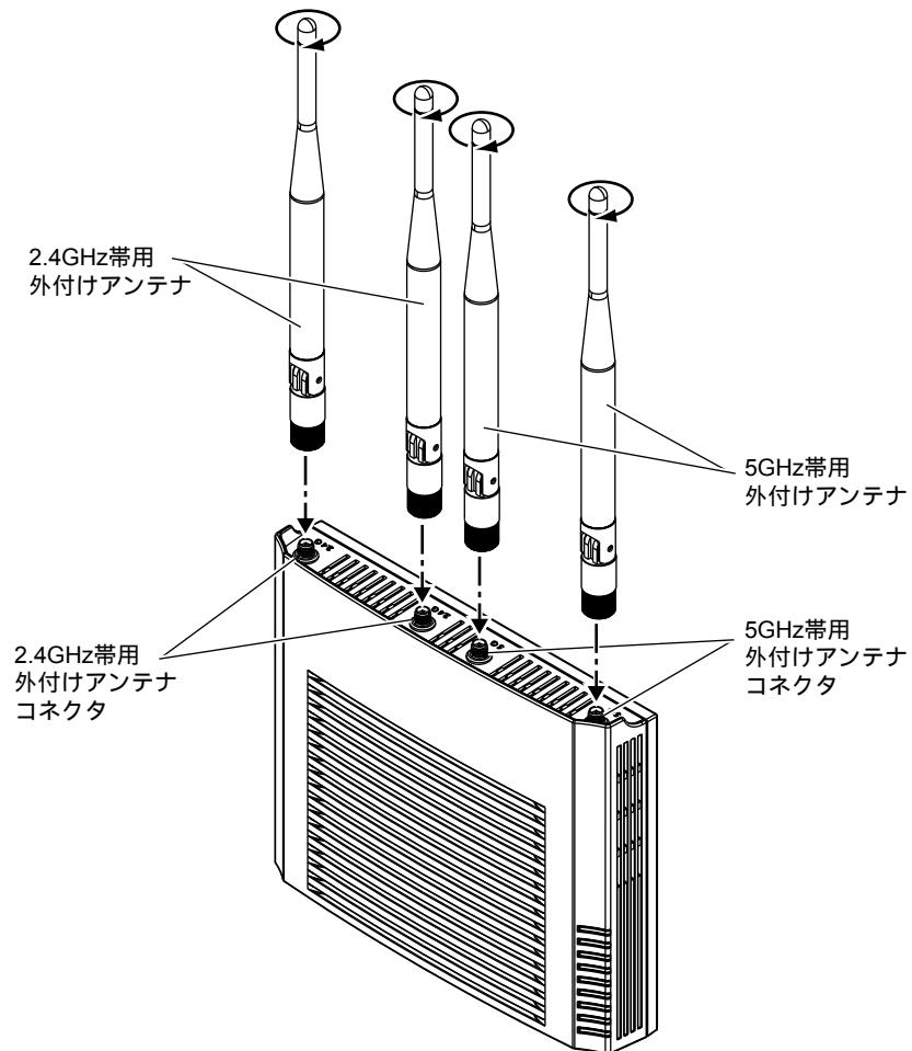
3. 外付けアンテナを折り曲げる場合は、下図の矢印の方向に動かします。
