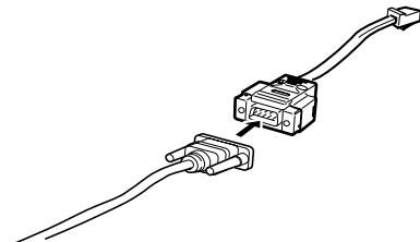
3. 本装置のコンソールポートにコンソールケーブルの RJ45 プラグを差し込みます。
