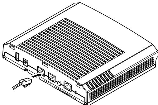
3. 給電装置にツイストペアケーブルを接続します。
