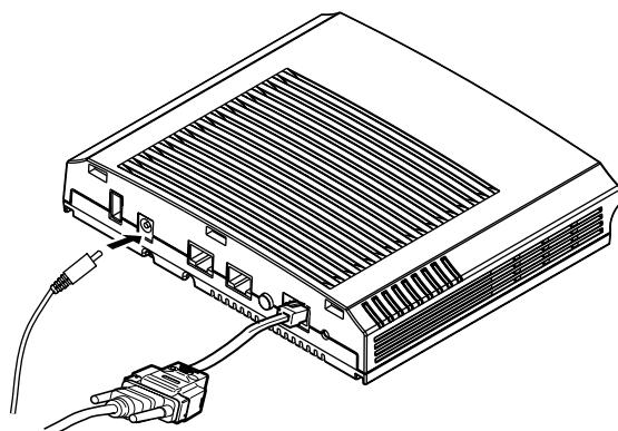
2. 本装置の底面にあるACアダプター抜け防止の溝に、ACアダプターのケーブルを固定します。
