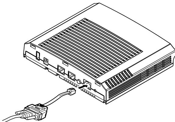
4. 先の細いもので本装置底面のリセットスイッチを押しながら、本装置に給電装置からのツイストペアケーブルを差し込みます。
