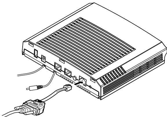
4. 先の細いもので本装置底面のリセットスイッチを押しながら、本装置の電源コネクタに ACアダプターを差し込みます。
