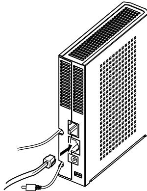
3. 先の細いもので本装置底面のリセットスイッチを押しながら、本装置の電源コネクタに AC アダプターを差し込みます。
