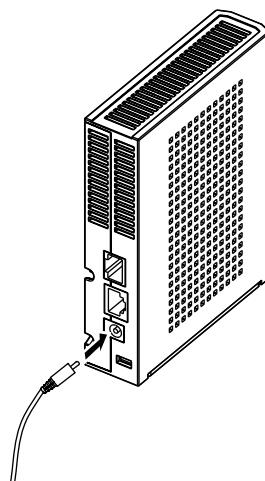
2. 本装置の側面にある AC アダプター抜け防止の溝に、AC アダプターのケーブルを固定します。
