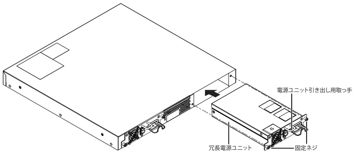
3. 固定ネジを締めて、冗長電源ユニットを本装置にしっかり固定します。
