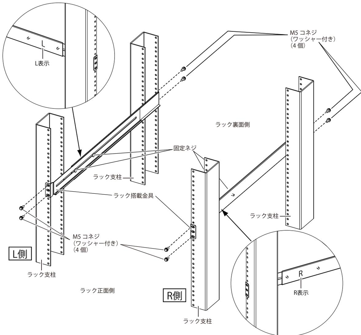
5. 本装置をラック支柱に取り付けたラック搭載金具に押しこむように入れ、プラスドライバーを使って、装置固定金具前面のつまみネジ（ネジサイズM5）で固定します。
