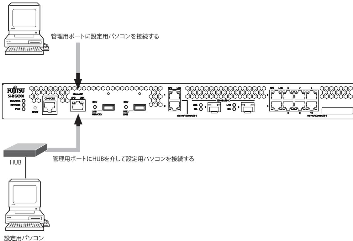
設定用パソコンと本装置をLANケーブル（ストレート）で直接つなぐ手順を説明します。
