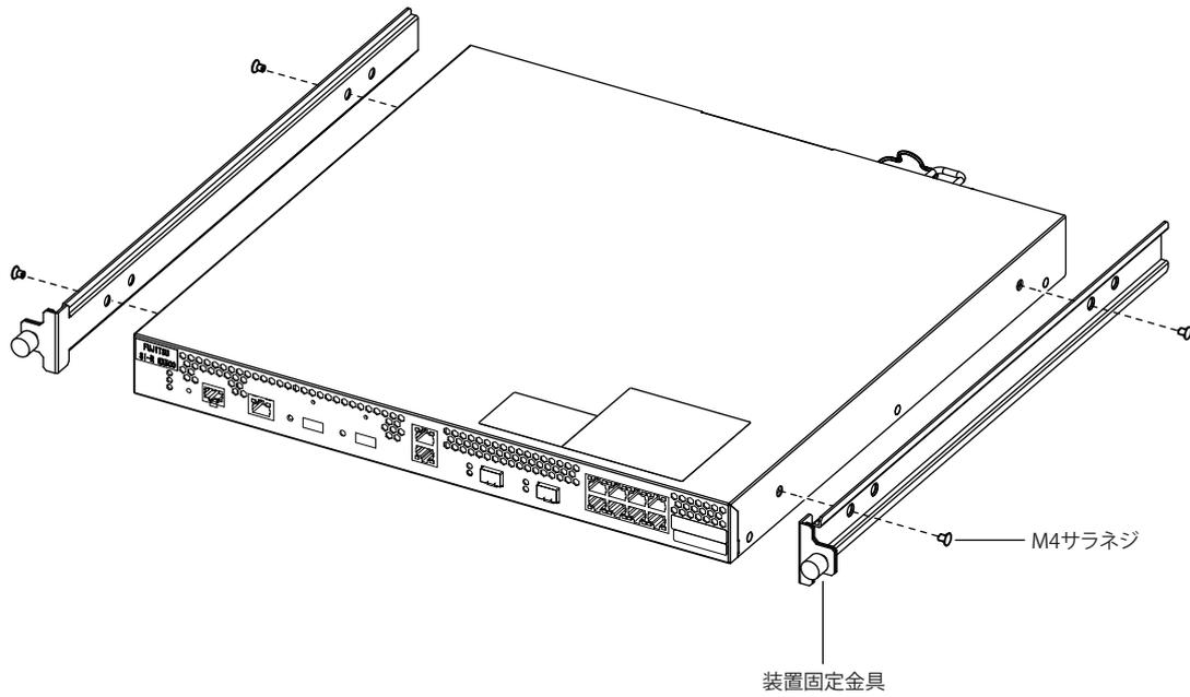
3. ラック搭載金具の固定ネジをいったんゆるめて、ラック支柱間の長さに調整します。
