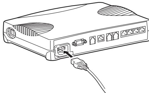
2. 電源ケーブルの先にアダプタプラグを取り付けます。
