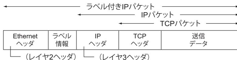
本装置では、MPLSのラベル配布プロトコルとしてLDP (Label Distribution Protocol) をサポートしています。LDPは、隣接LSRとLDPセッションを確立し、OSPFやRIPなどでやり取りされる経路情報を元にラベル生成を行い、メッセージ交換によりラベル配布を行うことでLSP (label Switching Path : トンネルラベルスイッチングパス) を構築するプロトコルです。
