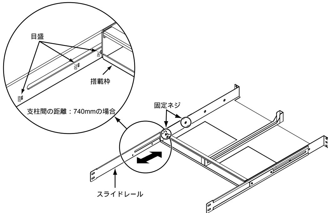
3. 搭載枠をラック正面側支柱の内側からケージナット（6個）、外側からM5ネジ（4個）で固定します。（中央部のケージナット2個は、手順5.で使用します。）
