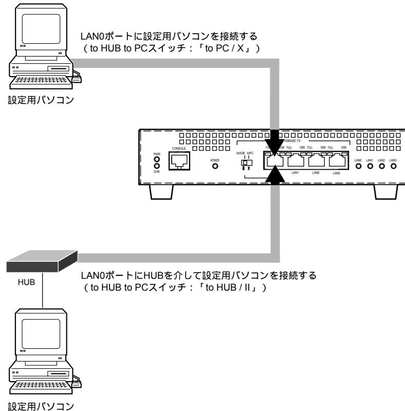
設定用パソコンと本装置をLANケーブル（ストレート）で直接つなぐ手順を説明します。
