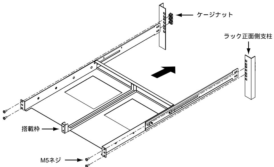
4. L字金具をラック裏面側支柱の内側からケージナット（4個）、外側からM5ネジ（4個）で固定します。
