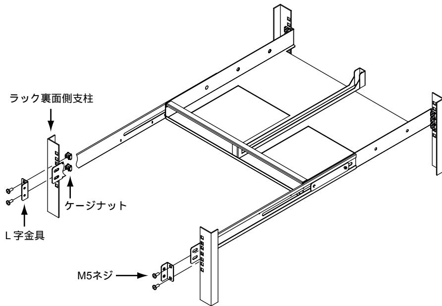
5. スライドレールをL字金具にM5ネジ（4個）で固定します。
