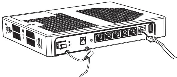
4. 先の細いものでリセットスイッチを押しながら電源を投入します。
