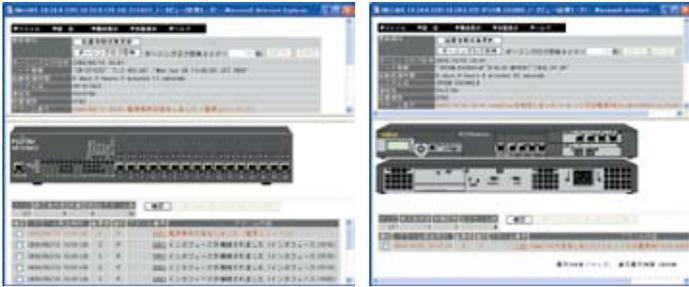
GS/PRIMEFORCE シリーズの LAN アダプタ (ONA など) から、IPCOM シリーズ、Si-R シリーズ、SR-S シリーズなどを集中監視します。最新機器も専用サイトから追加モジュールをダウンロードして監視サーバへ組み込むだけで、即時監視可能となります。
