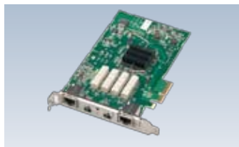
バイパス機能つきインターフェースカードB 製品型名: IX231GT2 標準価格: ¥250,000 備考: 1000BASE-T×2ポートバイパス機能付き。1枚のみ搭載可能。
