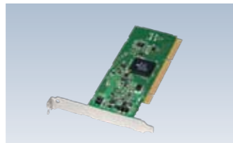
暗号カードA 製品型名:IX101CP1 標準価格: ¥150,000 備考:暗号化アクセラレーションカード1枚のみ搭載可能。
