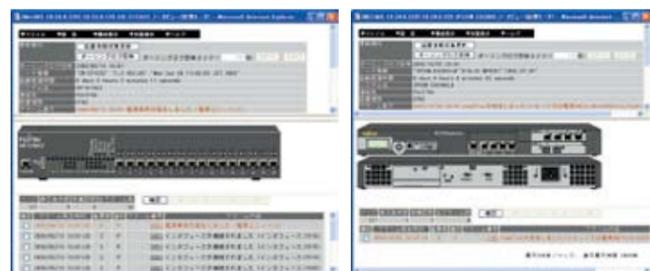
GS / PRIMEFORCE シリーズの LAN アダプタ (ONA など) から、IPCOM シリーズ、Si-R シリーズ、SR-S シリーズなどを集中監視します。最新機器も専用サイトから追加モジュールをダウンロードして監視サーバへ組み込むだけで、即時監視可能となります。
