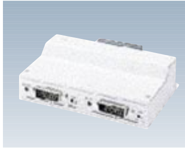
F9190E22 マルチトランシーバ 【型名：F9190E22】 標準価格：¥35,000 10BASE5(AUI)×2 130×95×36mm / 0.4kg 1.0W / 3.8KJ/h 備考：機器2台を10BASE5幹線へ接続
