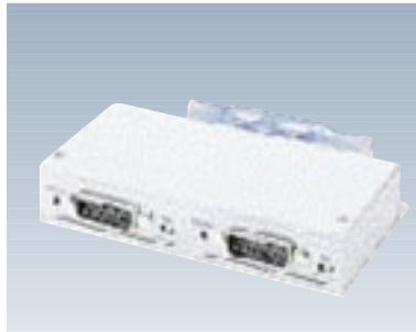
F9190F22 マルチトランシーバ 【型名：F9190F22】 標準価格：¥35,000 10BASE5(AUI)×2 130×80×25mm / 0.31kg 1.0W / 3.8KJ/h 備考：機器2台を10BASE2幹線へ接続
