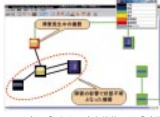
リンク切れ発生時は障害状態と不明状態を区別して表示
