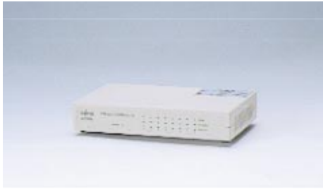
GeoStream SH1508M スイッチングハブ マグネット付小型低価格スイッチングハブ
