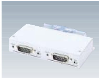
F9190F22 マルチトランシーバ 【型名：F9190F22】 標準価格：¥35,000 10BASE5(AUI)×2 130×80×25mm / 0.31kg 1.0W / 3.8KJ/h 備考：機器2台を10BASE2幹線へ接続
