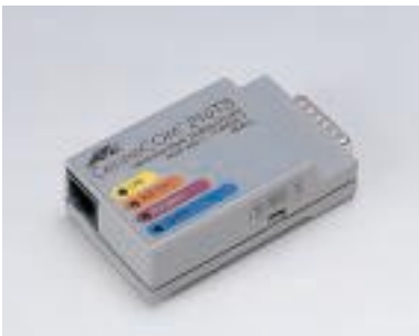
LFA-R0535 トランシーバ 【型名：LFA-RO535】 標準価格：¥8,800 10BASE5(AUI)×1、10BASE-T×1 43×78×23mm / 0.06kg 2.5W / 9KJ/h 備考：AUI機器をハブに接続する時に使用 [ファミリーハード製品]
