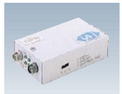
F9190RT1 リモートトランシーバ 【型名：F9190RT1】 標準価格：¥80,000 10BASE5 (AUI) ×1 光ケーブル (GI、短波、FCコネクタ) ×1 43×83.5×21mm/0.1kg 0.8W/2.9KJ/h 備考：10BASE5/2間を光ケーブルで接続 (トランシーバが必要)
