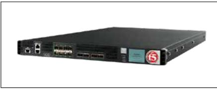
「BIG-IP Local Traffic Manager (BIG-IP LTM)」は、日々進化するビジネスアプリケーションに対応する柔軟性を備え、ICTインフラ全体を最適化するアプリケーション・デリバリ・コントローラーです。アプリケーションやサーバを理解したインテリジェントな機能により、より安全に、より高速に、より安定してアプリケーションを配信するだけでなく、アプリケーションやサーバの負荷をオフロードすることでリソースの有効活用を実現します。さらに、拡張性や管理の容易さも提供します。
