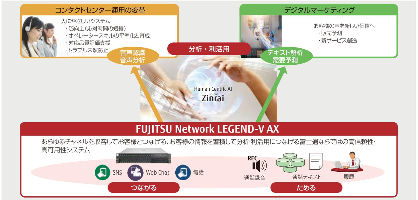
「FUJITSU Network LEGEND-V AX」は、呼制御機能とコンタクトセンターを円滑に運営するための機能(ACD機能、コール運用管理機能、音声自動応答機能(IVR)など)を、ワンプラットフォームに集約したコンタクトセンター専用システムです。
