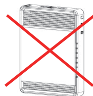
上下逆に設置
