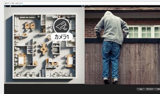
監視端末の警報ポップアップイメージ (左：マップ、右：検知場所のリアルタイム映像)
