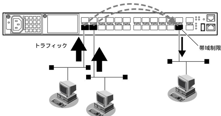
本装置は、出力の制限値を設定し、帯域幅をポート単位で制御します。トラフィックの帯域幅がしきい値を超えた場合は、帯域幅を超えるトラフィックが破棄されます。
