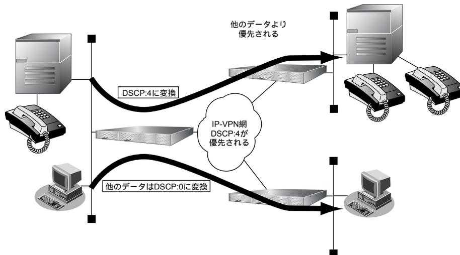
DSCP 値書き換え機能は、IPv4 [RFC791] で定義されている IP パケットヘッダにある 8 ビットの Type Of Service (TOS) フィールドおよび IPv6 パケットヘッダにある 8 ビットの Traffic Class フィールドのうち、DSCP フィールドを制御することができます。
