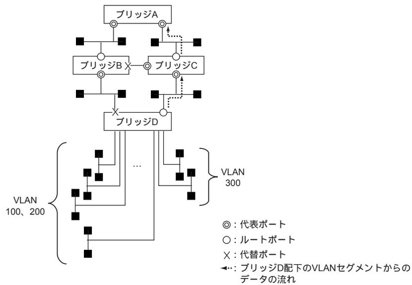
MSTPを使用すると、「インスタンス1でのスパンニングツリーとVLAN100、200のデータの流れ」、「インスタンス2でのスパンニングツリーとVLAN300のデータの流れ」のようにVLAN単位でのロードバランシングが可能です。STPのみの場合は、以下のようにVLANに関係なくスパンニングツリーが作成されるためデータが偏ります。
