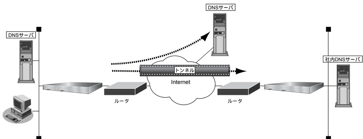
本装置が端末からDNSのQueryメッセージを受信した場合、DNS振り分けテーブル内に、問い合わせ先のドメイン名と一致するエントリが存在するかどうかをチェックします。一致するエントリが存在する場合は、その一致したエントリのDNSアドレスにメッセージを転送します。一致するエントリが存在しない場合は、デフォルトDNSアドレスにメッセージを転送します。
