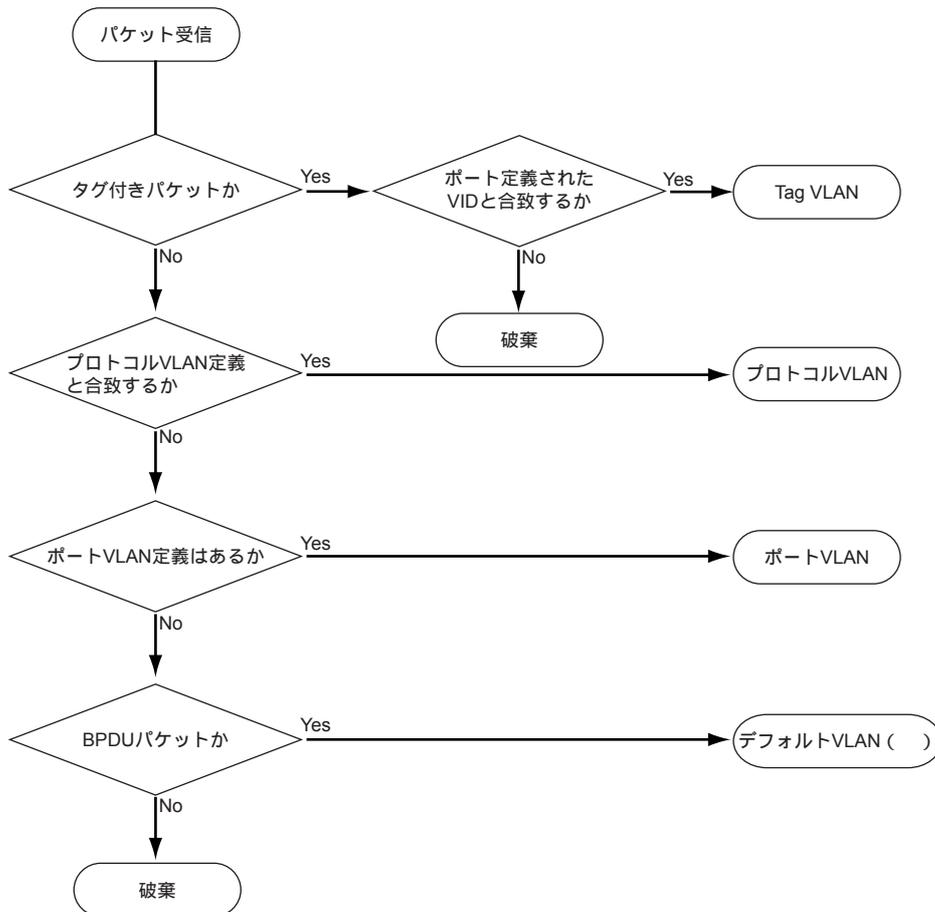
※) 本装置では、構成定義でTag VLAN / プロトコルVLANが定義され、かつ、ポートVLAN (untagged) が未設定のポートに対しては、BPDUパケットを受信するために装置内でデフォルトVLANを作成します。
